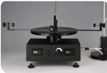
平衡臂利用光学传感器触动，补偿基座旋转，达到防止实验中动物管路缠绕打结。光学传感器的灵敏度大于其他触动方式，且平衡臂可调整长度和高度，可以满足一台机器应用于大鼠、小鼠等不同物种的实验。
